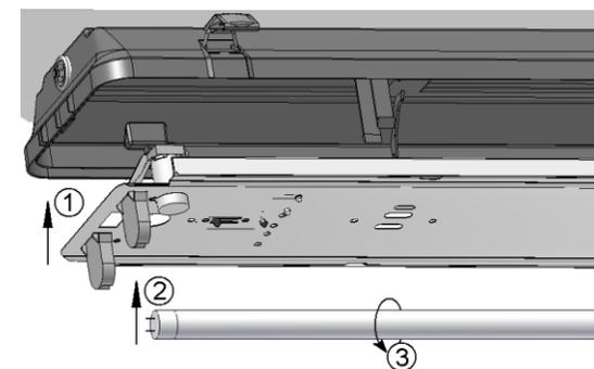
7 Одеть рассеиватель на корпус светильника и закрепить его защелками.
