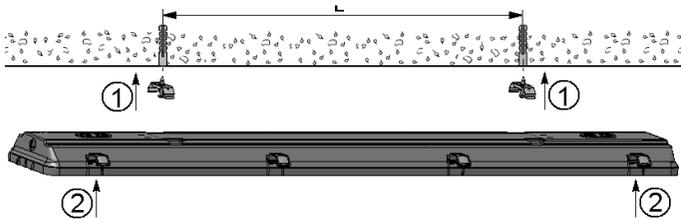
Для светильника ARCTIC: просверлить установочные отверстия на поверхности потолка и в корпусе светильника на расстоянии L.
