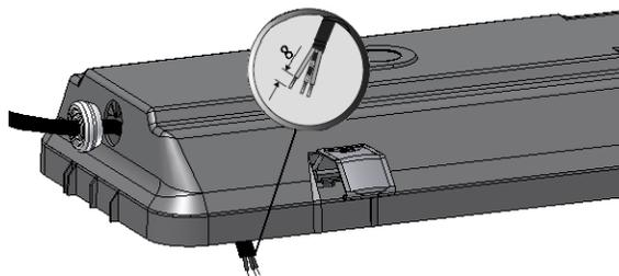
5 Подключить сетевой провод к клеммной колодке на монтажной панели в соответствии с указанной полярностью:
